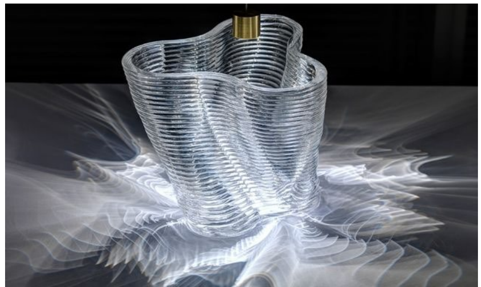
3D-Printed Transparent Glass – Neri Oxman Et al. via MIT News
